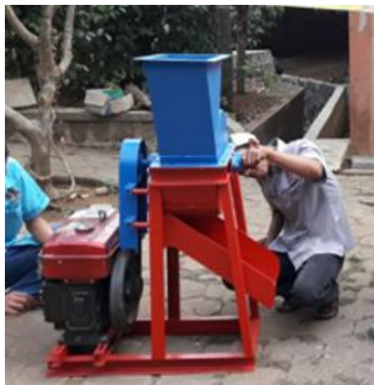
Gambar 4 Mesin penghancur dan pelumat pupuk berasal dari kotoran sapi.
